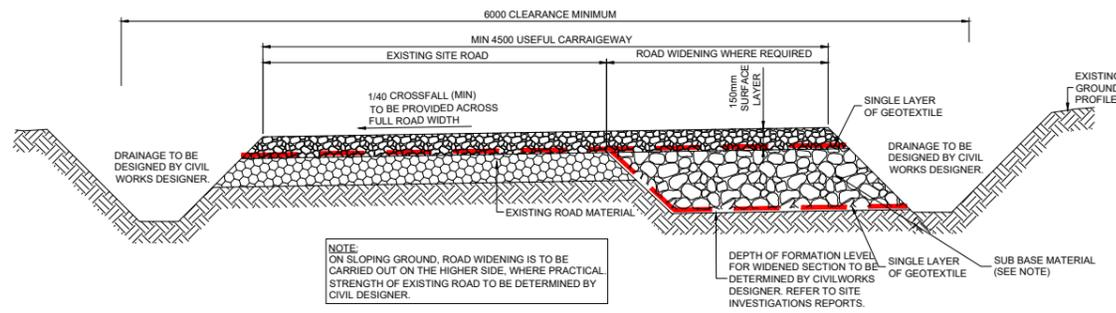
ROAD WIDENING ON EXISTING SITE ROADS WHERE REQUIRED CONSTRUCTION PHASE
